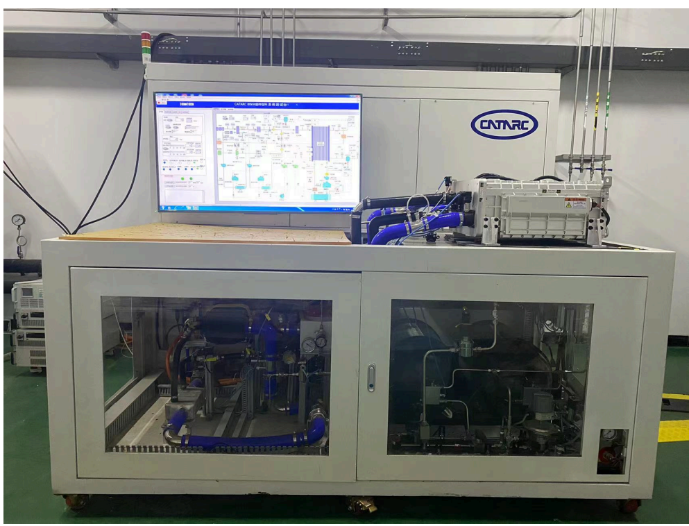
Nền tảng CIL 80 kW: tích hợp linh kiện ô tô thực với hệ đo và điều khiển
