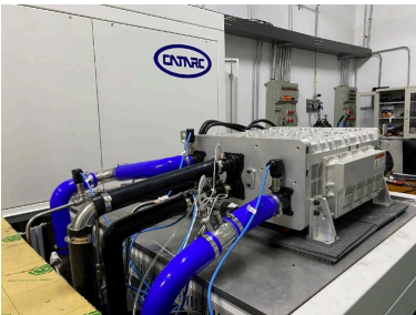
Cụm pin thực + cấp khí, làm mát, tải điện
