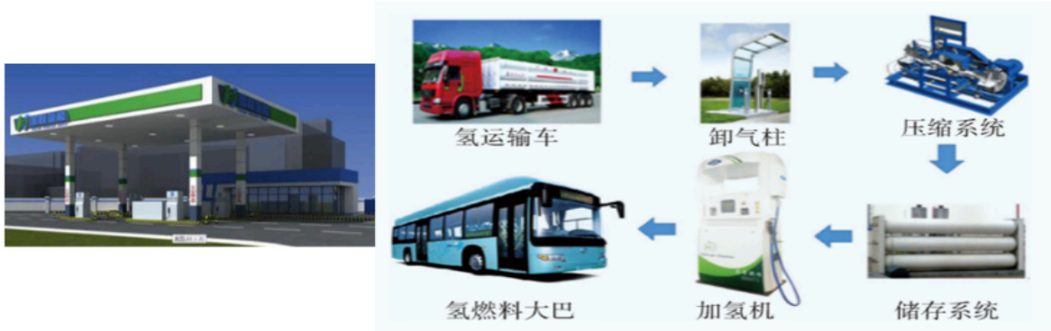
Sơ đồ vận chuyển, nạp hydro và vận hành xe (hình gốc dự án)
