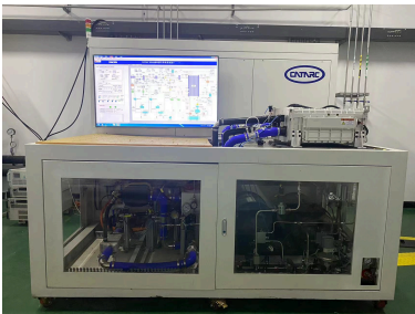
Cấp khí, tuần hoàn H 2 , làm mát: linh kiện thực
